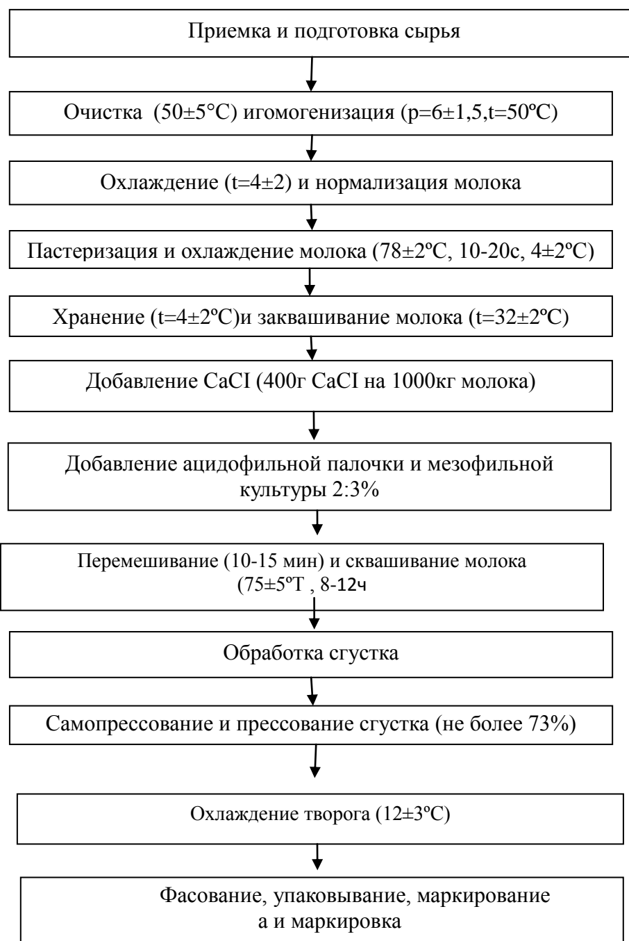
Рис.2. Предлагаемый технологический процесс производства творога с внесением ацидофильной палочки и мезофильного стрептококка.
